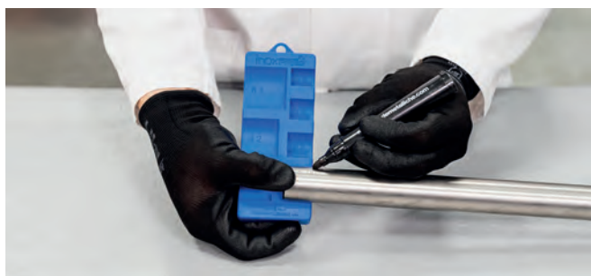
Bilde 30 – Merke innsettsdybden
