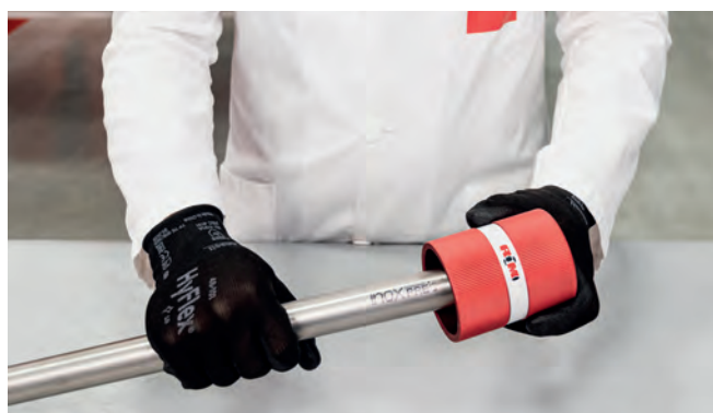
Bilde 27 – Avgrading av rør
